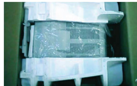
Acondicionamento específico de alta densidade e apropriado em caixa nova de cartão canelado duplo
